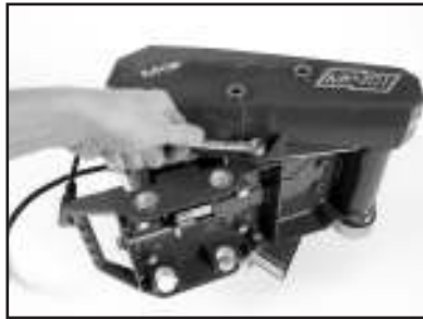
(D) Remove Belt Guard bottom bolt
